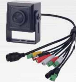
Telecamera pin-hole IP H.265, risoluzione 2 Mpixel, ottica fissa pin-hole 3,7 mm (84°), sensore 1/2,8" Progressive Scan CMOS, risoluzione 1920x1080 30 fps, 2D/3D-DNR, WDR> 120 dB, ICR, menù OSD in lingua italiana, compressione H.265/H.264/MJPEG, slot per scheda di memoria SD/SDHC max 128 GB, compatibile ONVIF, Main stream 500÷12000 kbps, Sub Stream 200÷8000 kbps, alimentazione 12 Vcc.
