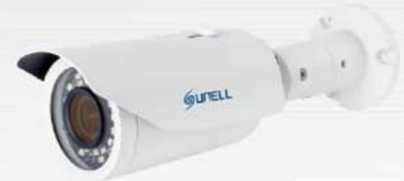
Telecamera bullet IP risoluzione 2 Mpixel, ottica varifocale 2,8÷12 mm (89°÷35°), sensore da 1/2,7" Progressive Scan CMOS, risoluzione 1920x1080 30 fps / 1280x720 30 fps, 30 led SMD IR per una illuminazione fino a 40 m, 2D/3D-DNR, dWDR, ICR, menù OSD in lingua Italiana, compressione H.264 High/Main/Baseline e MJPEG, compatibile ONVIF, Main stream 500÷12000 kbps, Sub Stream 100÷6000 kbps, IP66, alimentazione 12 Vcc / POE.
