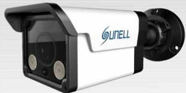
Telecamera bullet IP H.265, risoluzione 4 Mpixel, ottica fissa 3,6 mm (84°), sensore 1/3" Progressive Scan CMOS, risoluzione 2592x1520 20 fps / 2304x1296 30 fps / 1920x1080 30 fps, 2 led IR Array proporzionali per una illuminazione fino a 30 m, 2D/3D-DNR, WDR> 120 dB, ICR, menù OSD in lingua italiana, compressione H.265/H.264/MJPEG, compatibile ONVIF Profilo G e S, CGI, Main stream 500÷12000 kbps, Sub Stream 100-6000 kbps, IP66, alimentazione 12 Vcc / POE.
