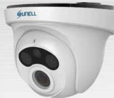
Telecamera eyeball IP risoluzione 2 Mpixel, ottica fissa da 2,8 mm (89°), risoluzione 1920x1080 30 fps / 1280x720 30 fps, sensore da 1/2,9" Progressive Scan CMOS, 2 led IR Array per una illuminazione fino a 15 m, 2D/3D-DNR, dWDR, ICR, menù OSD in lingua Italiana, compressione H.264 High/Main/Baseline e MJPEG, compatibile ONVIF, CGI, Main stream 500÷12000 kbps, Sub stream 100÷6000 kbps, IP66, alimentazione 12 Vcc / POE.
