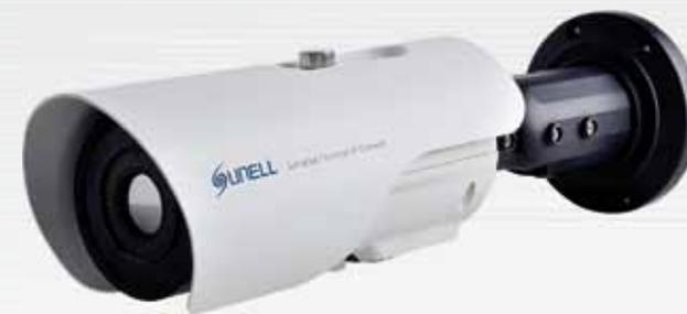
Telecamera bullet termica IP, risoluzione 420x315, sensore Uncooled FPA, sensibilità termica 50 mK, lunghezza d'onda rilevata 8÷14 µm, ottica da 8 mm / 15 mm / 25 mm / 35 mm / 50 mm, possibili visualizzazioni: bianco/nero, effetto incandescente, effetto arcobaleno ed effetto ruggine. IP66, alimentazione 12 Vcc / POE.
